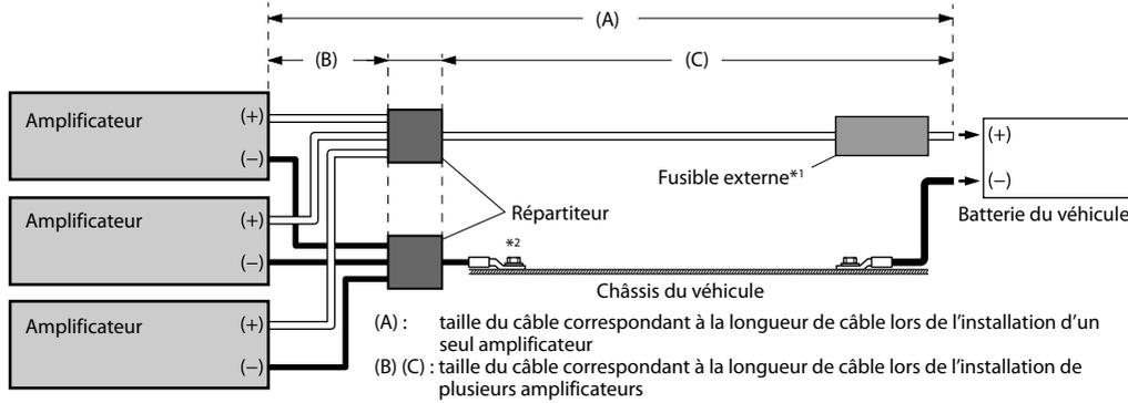
\*1 Veuillez à ajouter un fusible externe (par exemple un boîtier à fusibles ou un disjoncteur) au fil de batterie aussi près que possible de la borne positive (+) de la batterie.
