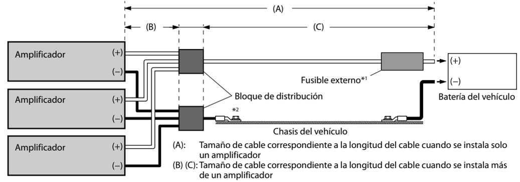
\*1 No olvide añadir un fusible externo (por ejemplo, un bloque de fusibles o un disyuntor) en línea con el cable de la batería tan cerca como sea posible del terminal positivo (+) de la batería.
